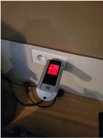
Photo socle de prise de terre non raccordée à la terre
